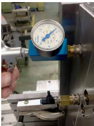
Ein Rückschlagventil in der Vorrichtung verhindert, dass die eingeblasene Luft entweichen kann.
