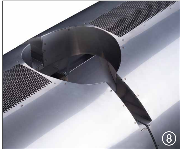
Detail Entgasungszone / Detail de-gassing zone
