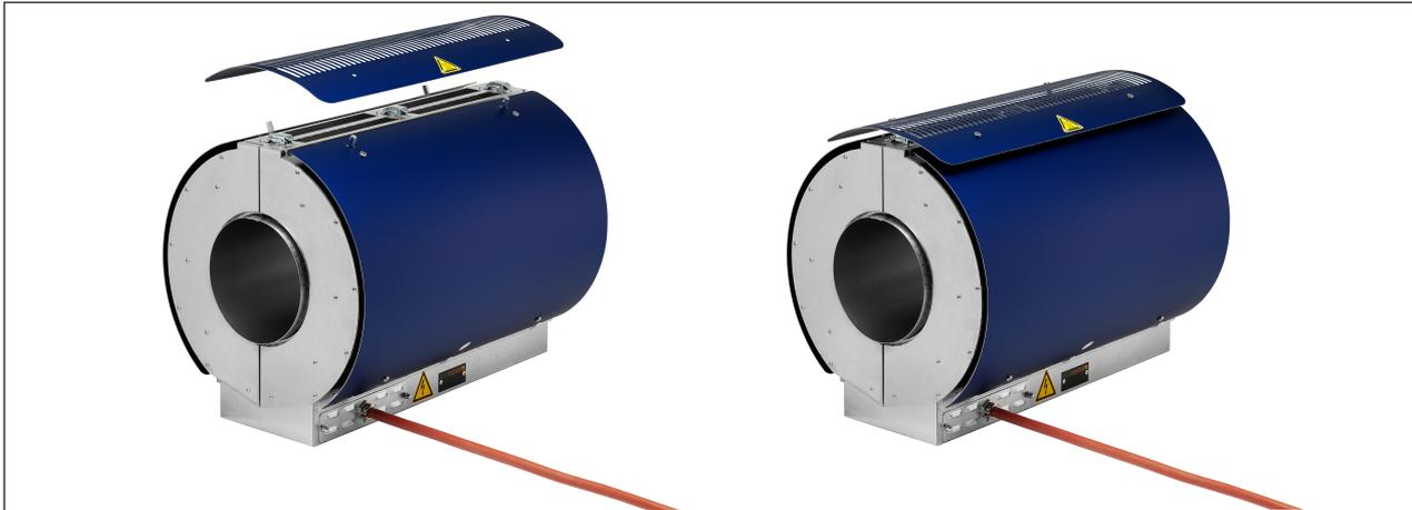
An die seitlichen Flanken des Ventilatorflanschgehäuses werden dann die doppelwandigen und mit einer 25 mm starken Isolierstoffeinlage gefüllten Isolierschalen angeschraubt. An der oberen Längsseite der Isolierschalen ist jeweils das **ECOWEMIA** - Konvektions-Klappensystem eingebaut. In den Heizphasen wird damit der Wärmeverlust durch freie Konvektion reduziert.
