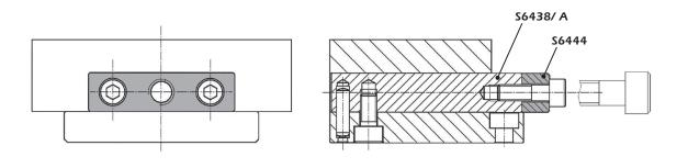
Zylinderflanschplatte zur Befestigung mit Hydraulikzylinder / Hydraulic cylinder flange for mounting with hydralic cylinder
