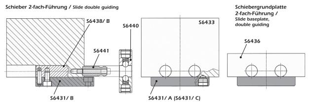
Tuschierleiste mit Schieber, 2-fach-Führung / Spotting bracket, with slide double guiding
