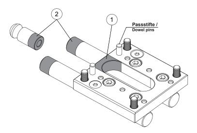
1) Wenn konstruktive Verhältnisse es erfordern, kann das Langloch in der Grundplatte der Schiebereinheit **S6431** entsprechend verändert werden (siehe ①).
